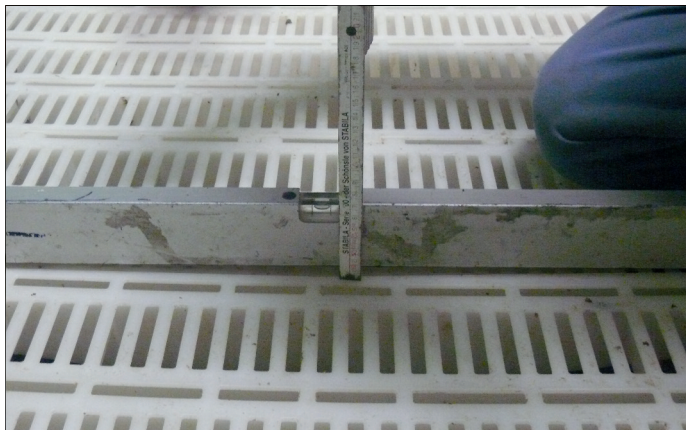
Mit Wasserwaage und Zollstock wurde überprüft, ob sich der Großflächenrost zu weit durchbiegt.
