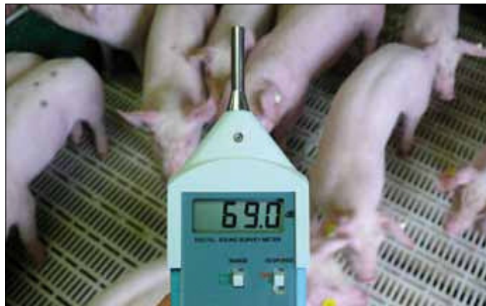
Der „Piccoletto“-Rost gehört bezüglich des Geräuschpegels eher zu den leiseren Kunststoffböden. Fotos: Schulte-Sutrum
